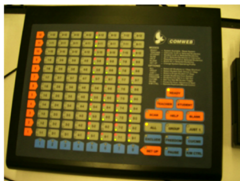
教官の側で各 PC に映し出す画面をコントロールできる。
